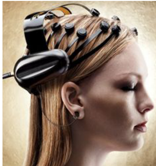
Figura 1. Sistema portatile di registrazione dell'attività elettrica cerebrale per monitorare l'attività mentale.
